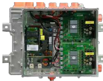
Unités de distribution d'énergie « PDU » (vue intérieure)
